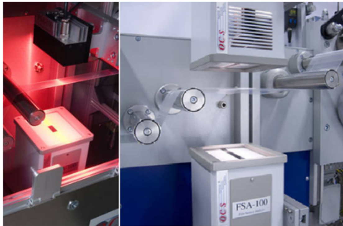
Figura 12. Extrusora de filme para verificação de impurezas, Optical Controler System – OCS , 2011.
