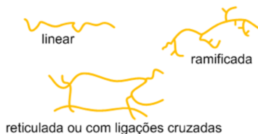
Figura 7. Alguns tipos de estruturas de moléculas poliméricas, adaptado de Akcelrud (2007).
