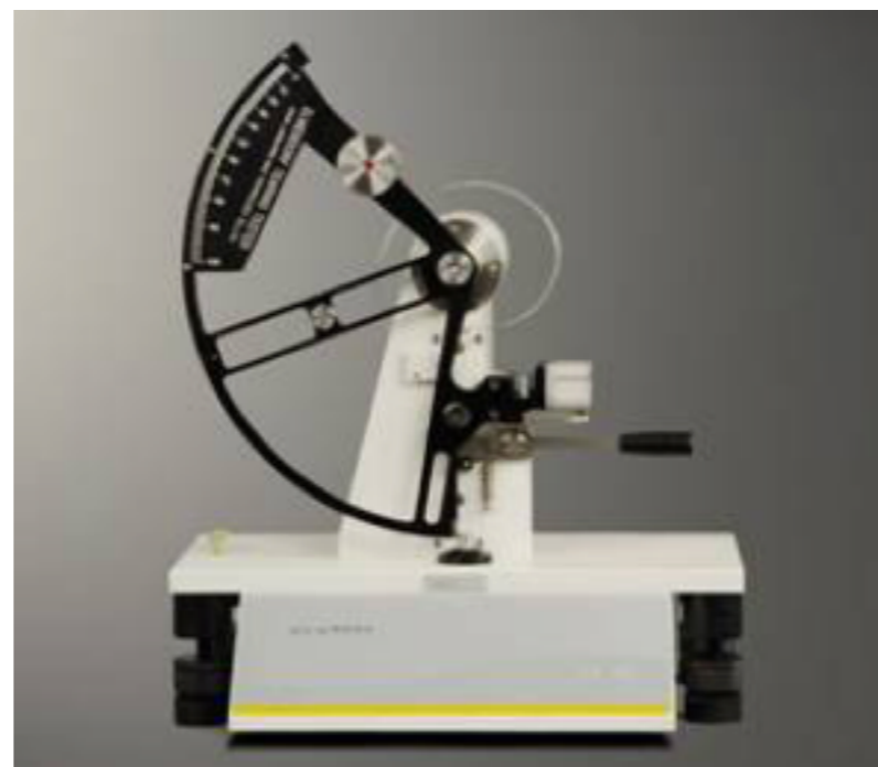
Figura 17. Instrumento para teste Elmendorf, Qualitest International Inc., 2011.
