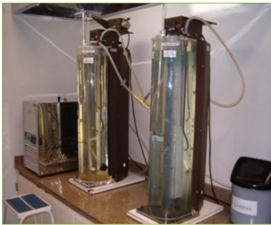
Figura 11. Tubo gradiente coluna de densidade do laboratório.
